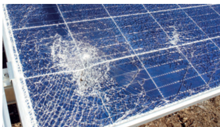
Photo 22 : Panneau photovoltaïque endommagé (© Andrei Merkulov/AdobeStock)
