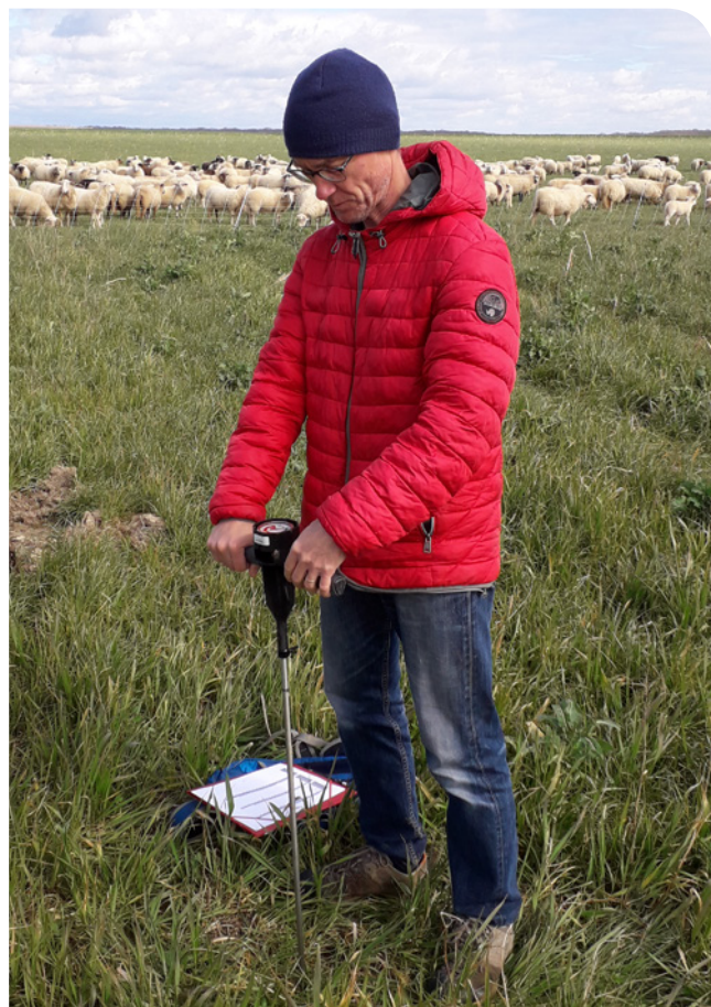
Les mesures au test bêche et au pénétromètre ne montrent pas d'effet important de compactage du pâturage des brebis
