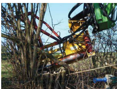
Figure 13 : Grappin coupeur en action (© Mission Haie Auvergne)
