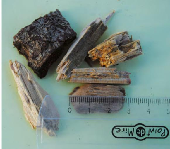
Inutile de changer le réglage de la déchiquetteuse pour les plaquettes de bois. Une taille de 3 cm convient parfaitement !
