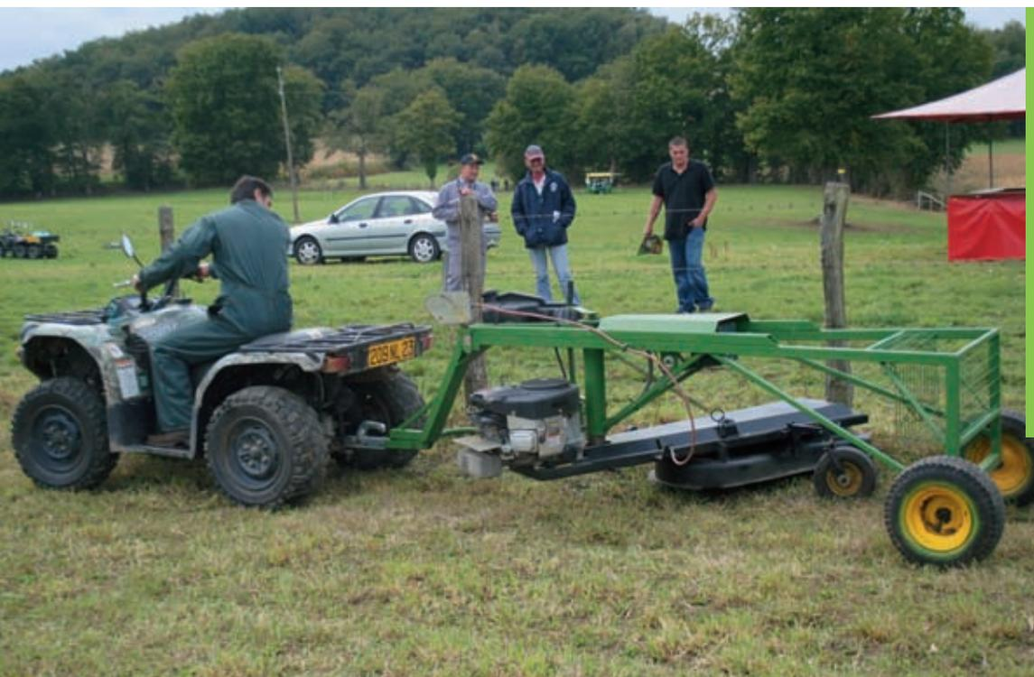
Un éleveur Creusois a mis au point ce broyeur sous clôture réalisé avec une coupe de tracteur tondeuse et un moteur bicylindre de 22 ch. Il est semi-porté et s'attelle derrière un quad. L'effacement est commandé par un système à ressort.
