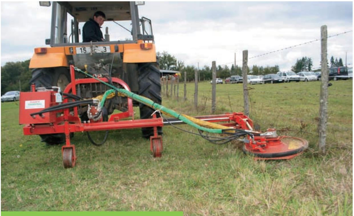
Ce modèle, prévu au départ pour couper l'herbe au pied des pommiers est équipé d'un rotor de 60 cm de diamètre et d'un palpeur hydraulique pour commander l'effacement. Un déport hydraulique de 1 m facilite le suivi de la clôture. Prix indicatif : 6 000 € HT.
