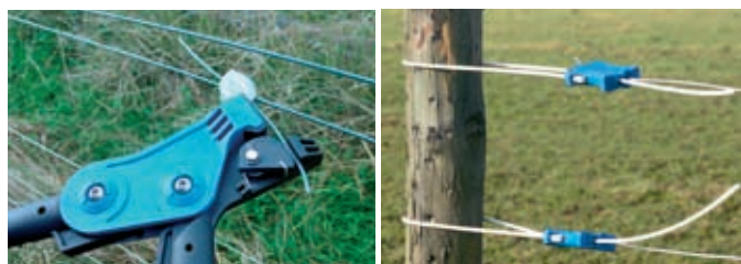
Le système « gripple » remplace les nœuds.
