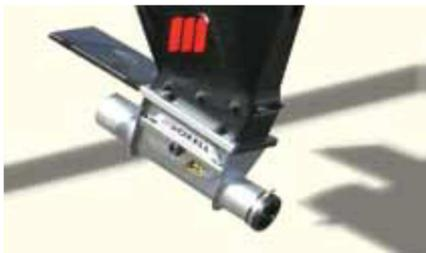
Le boitard de reprise est différent s'il s'agit d'une vis rigide ou d'une vis souple.
