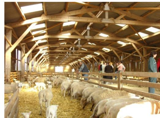
La bergerie est le plus souvent équipée d'un couloir central. Il faut également vérifier la bonne ventilation du bâtiment. 2m<sup>2</sup> d'aire paillée sont à prévoir pour une brebis et ses 2 agneaux. La place à l'auge est de 40 cm pour une brebis en fin de gestation, de 33 cm en lactation. Un parc de tri ou des cornadis sont conseillés. Un espace pour l'allaitement artificiel est impératif.
